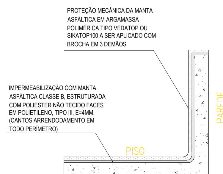
03 DETALHE ENCONTRO DE PISO/PAREDE ESC.: 1/20
