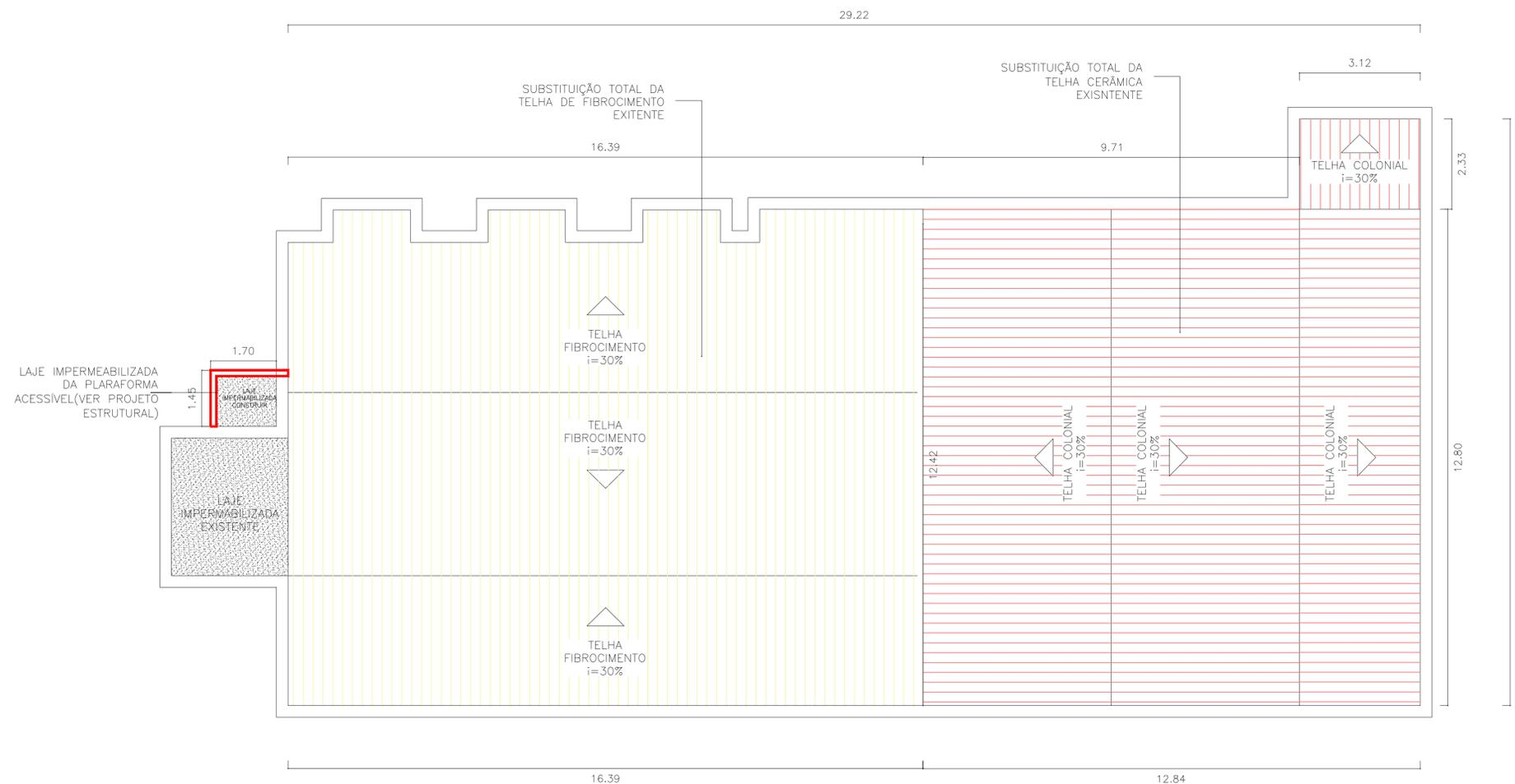
**12 PLANTA DE CONSTRUÇÃO/DEMOLIÇÃO COBERTA**
