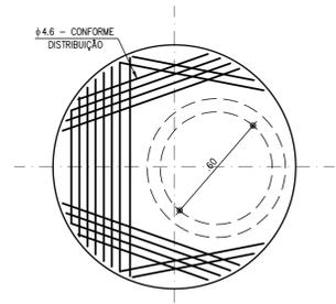
LAJE SUPERIOR - PLANTA DE FERRAGEM
