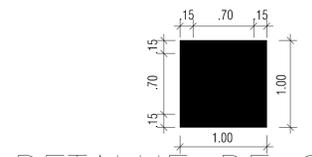
DETALHE DE SINALIZAÇÃO NO SOLO PARA EXTINTOR SEM ESCALA
