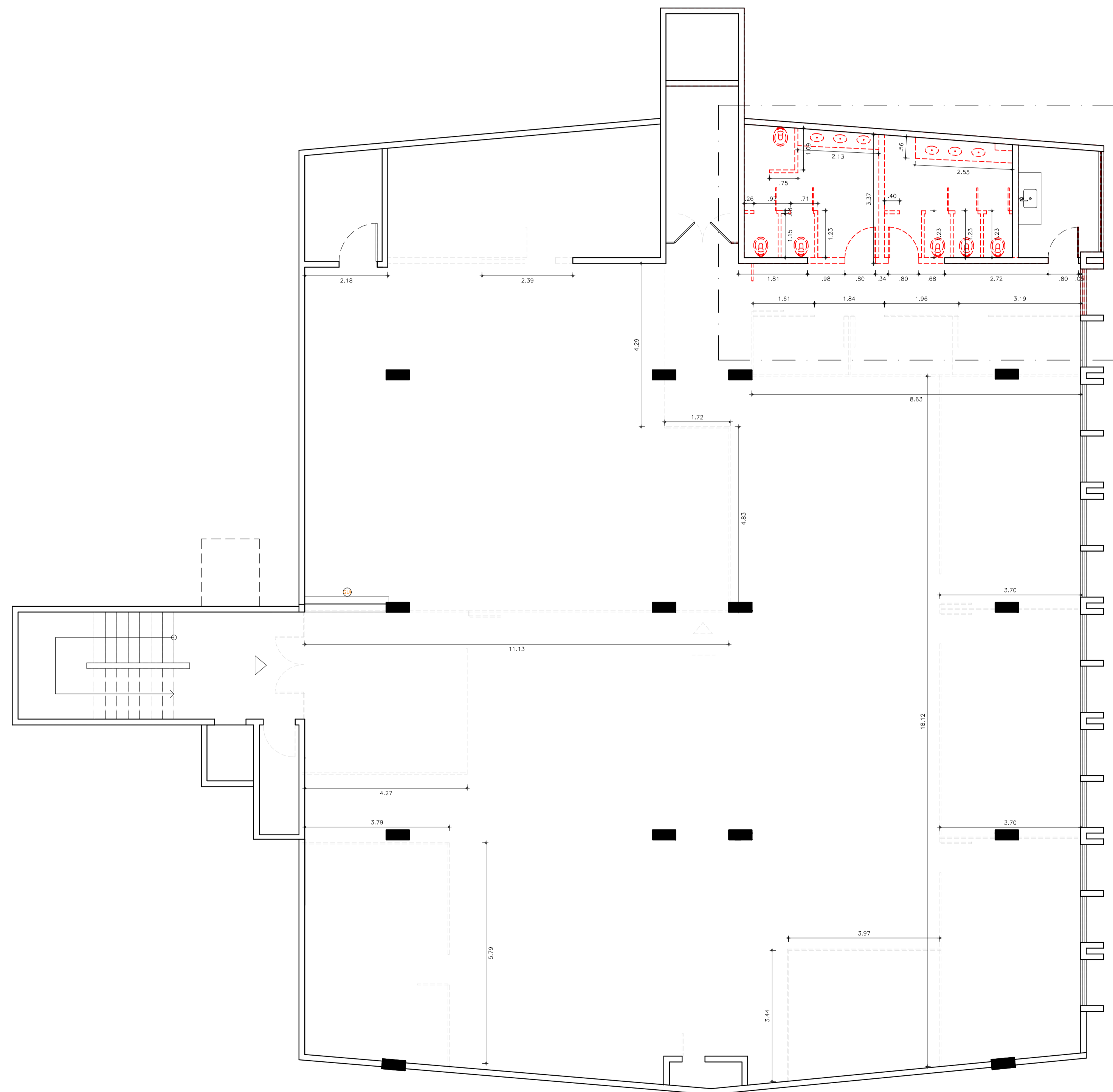
4 PLANTA DE DEMOLIÇÃO 3º ANDAR ESCALA 1/75
