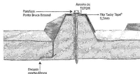
A fixação no onda alta garante a estanqueidade.
