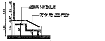
9 CORTE AA DET ARQUIBANCADA ESCALA 1:50
