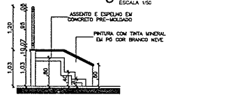
10 CORTE BB DET ARQUIBANCADA ESCALA 1:50
