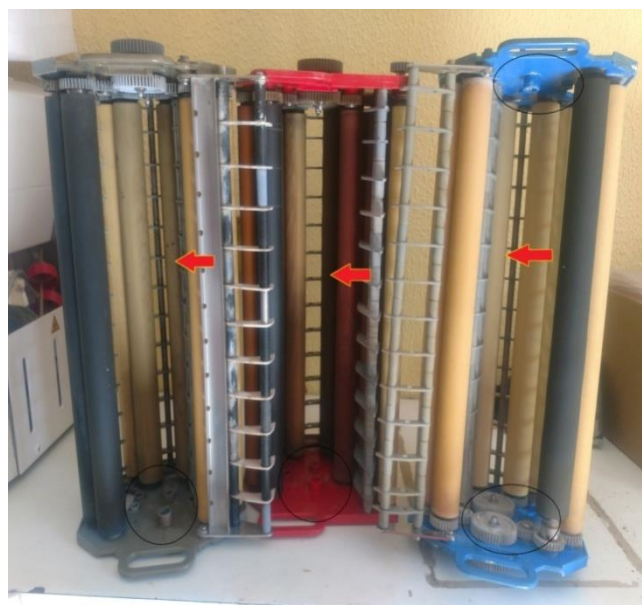
Foto 2: Peças para a processadora: Hack do Fixador, Hack do Revelador, Hack da Água.
