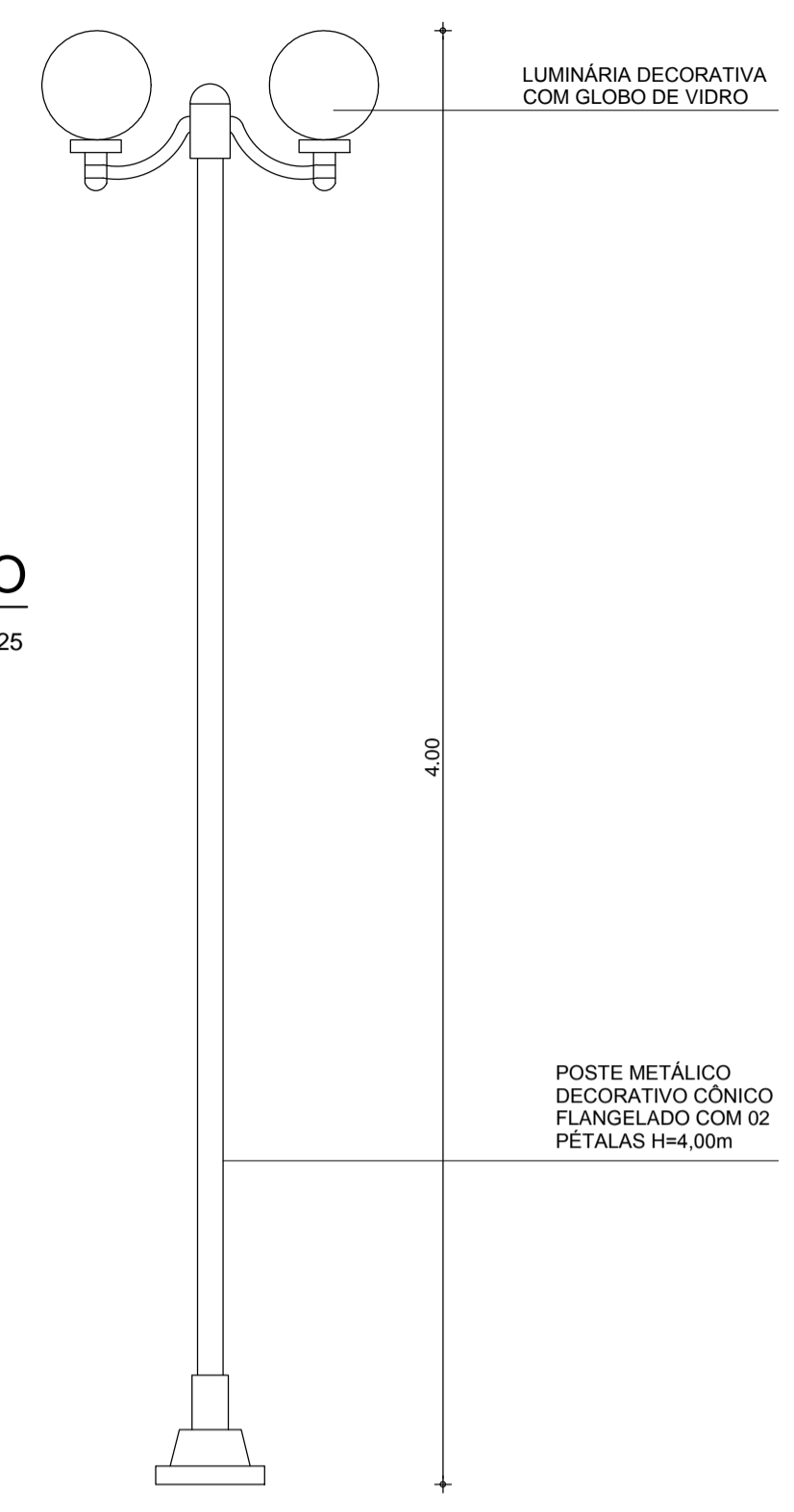
05 VISTA POSTE GLOBO DE VIDRO ESCALA 1/25
