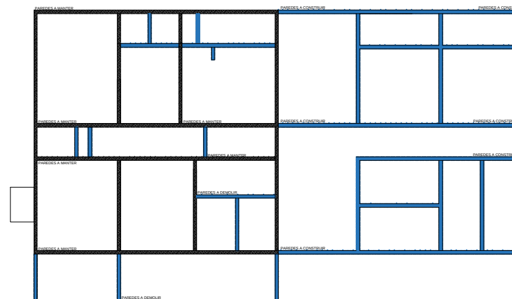
2 PLANTA DE CONSTRUÇÃO E DEMOLIÇÃO ESCALA 1/75
