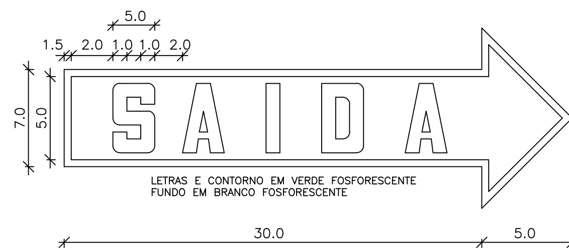
LUMINOSO AUTÔNOMO DETALHE SETA INDICADORA DE SAÍDA SEM ESCALA DIMENSÕES EM CENTÍMETROS
