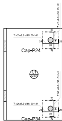
Armação positiva dos capitéis do pavimento ALT 325 escala 1:50
