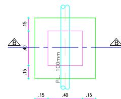
PLANTA BAIXA-CAIXA DE INSPEÇÃO
