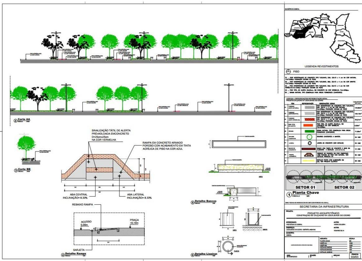
Fig.3: Cortes e Detalhes de Construção de Calçada, Localidade Cedro , Jaibaras, Sobral, CE.
