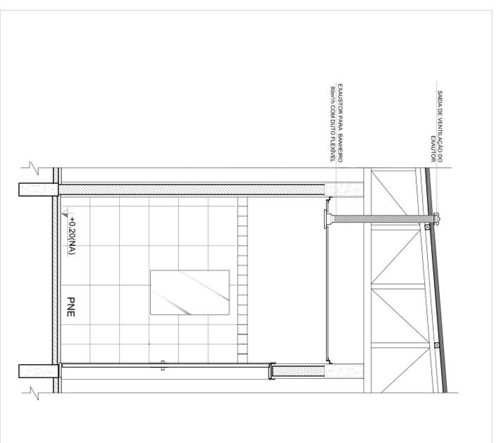
4 DETALHE - TUBULAÇÃO VERTICAL E EQUIPAMENTO
