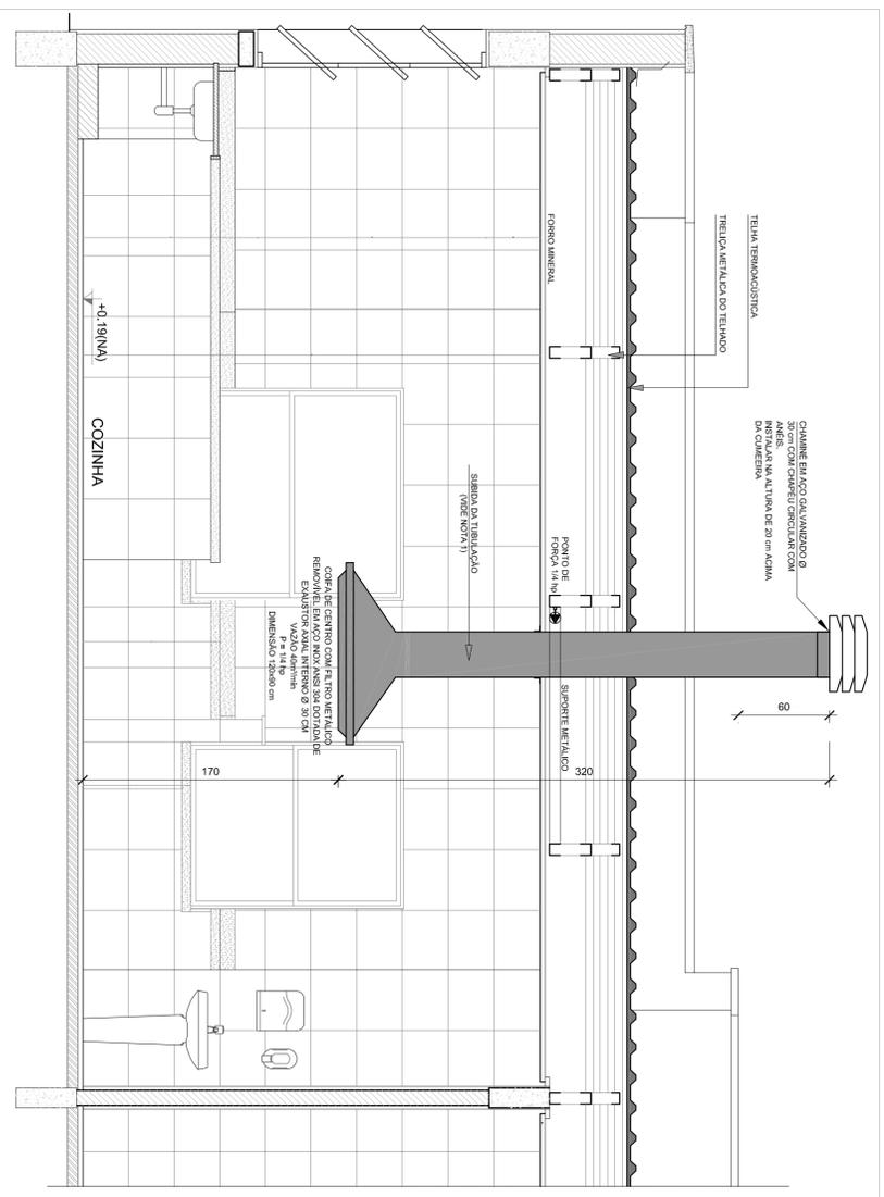
2 DETALHE - TUBULAÇÃO VERTICAL E EQUIPAMENTO
