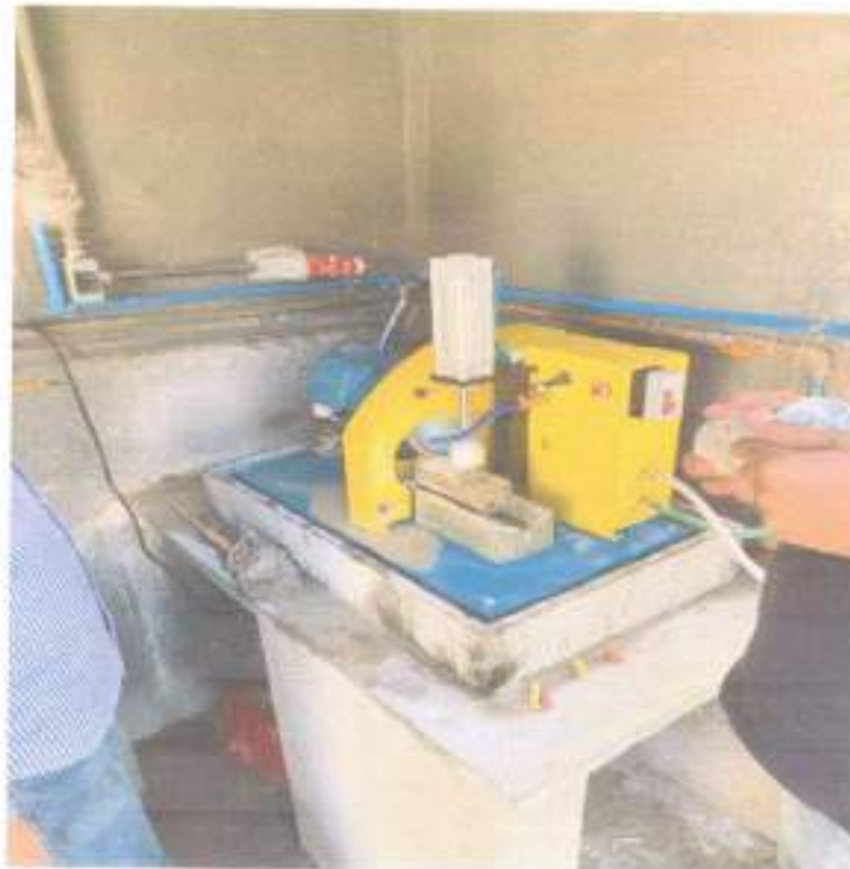
Figura 04 – Ensaio com testemunhos de concreto - ETE.
