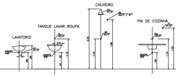
08- ESQUEMA VERTICAL PONTOS DE ÁGUA E ESGOTO
