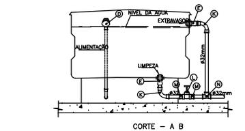
DETALHE EXECUTIVO HIDRAULICO INSTALAÇÃO DA CAIXA D'ÁGUA CAPACIDADE 1.000 Lt
