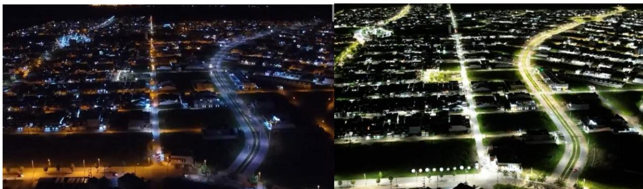
Figura 5 – Antes e depois da instalação da substituição de luminárias convencionais de vapor por LED no bairro Renato Parente.
